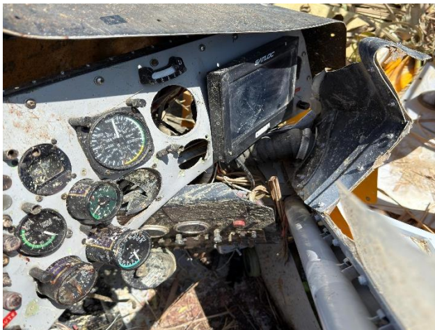
Fig. 3 – Daños en el panel de instrumentos de la aeronave.
