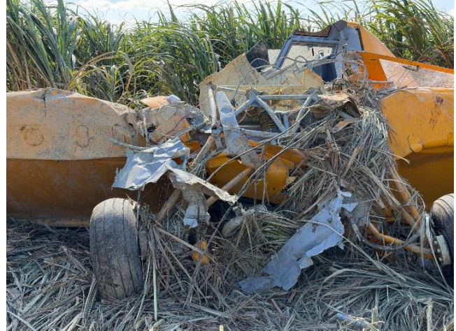
Fig. 4 – Daño frontal y tren de aterrizaje principal de la aeronave.
