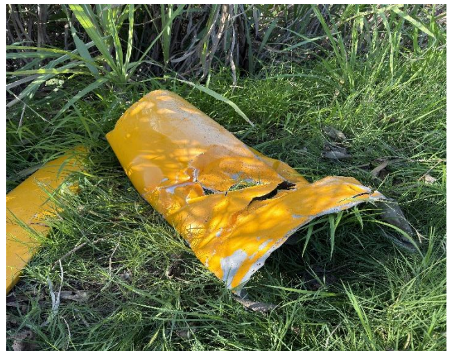
Fig. 6 – Restos de la punta de ala del lado derecho, en el primer contacto de la aeronave contra el obstáculo.
